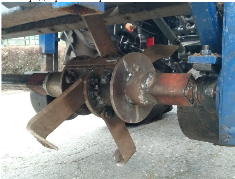
Рисунок 11 - Общий вид секции почвообрабатывающей фрезы с предохранительным устройством фрикционного типа
