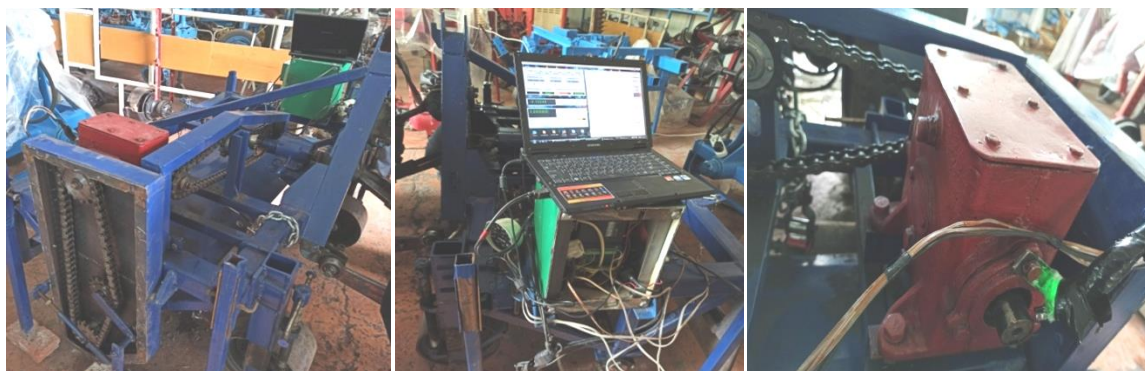
Рисунок 4 – Общий вид цепного привода с редуктором, измерительного блока с аналого-цифровым преобразователем Zet210 и дифференциальным усилителем Zet411с портативным компьютером с запущенным программным обеспечением измерительного комплекса ZetLab и вид датчика установленного на корпусе редуктора машины для подсчета перемещения (количества оборотов) в процессе вращения вала фрезы от ВОМ трактора
