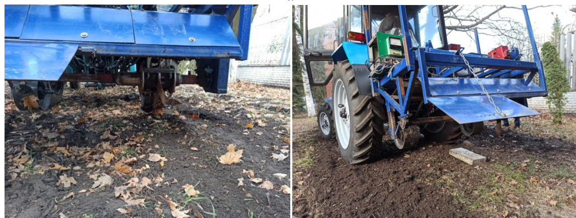
Рисунок 5 – Общий вид машины с измерительным оборудованием и экспериментальной секцией фрезы с фрикционным предохранителем при проведении лабораторно-полевых опытов процесса обработки почвы и обхода препятствий (камней) с приводом машины от ВОМ трактора МТЗ-80Л (вид а) и МТЗ-82 (вид б)
