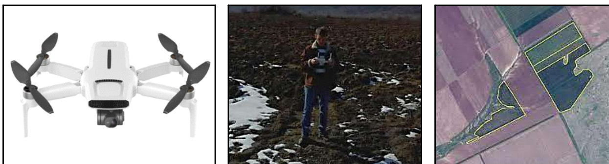
Рис. 1. БПЛА, используемый в работе (а), проведение съемки ДМ (б) и процесс разработки электронной карты рабочих участков (в).
