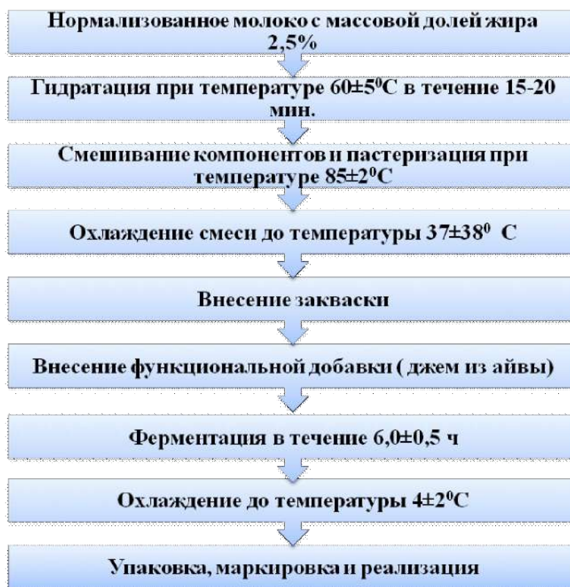
Рис. 1. Технологическая схема производства кисломолочного десерта с айвовым наполнителем.
