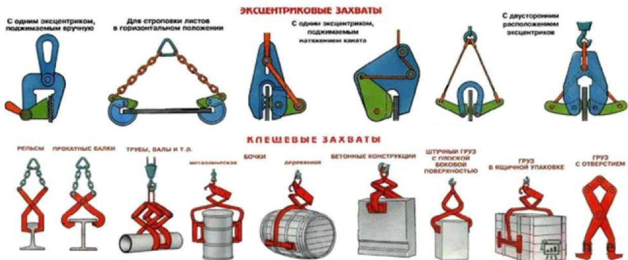
Рис. 1. Общий вид и устройство различных по конструкции и назначению клещевых и эксцентриковых захватов (вид а).
