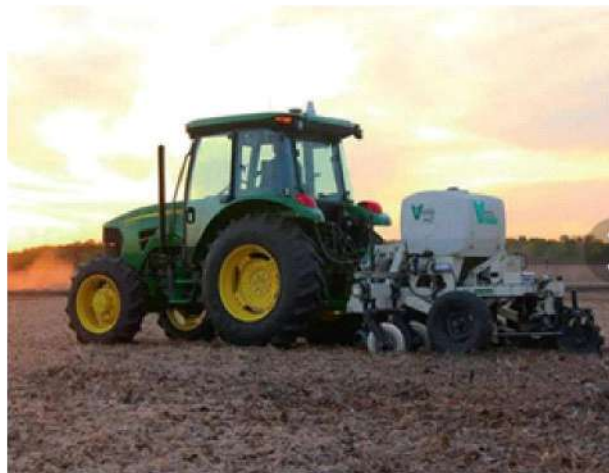
Рис. 1. Общий вид машинно-тракторного агрегата, оснащенный техническим средством для сканирования почвы.
