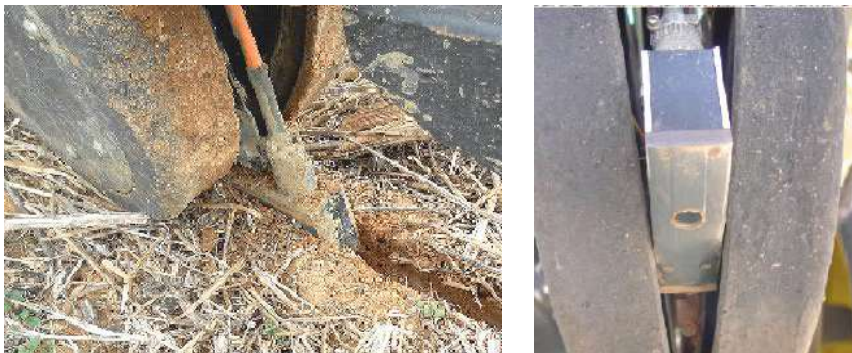
Рис. 2. Оптический сенсор для сканирования почвы на содержание органического вещества (ОМ).
