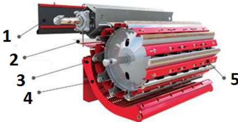
Рис. 2 – Устройство молотильного барабана Across 585 фартук соломотряс___; решетка предохранительная___; фартук деки___; подбарабанье сменное___; щиток___.
