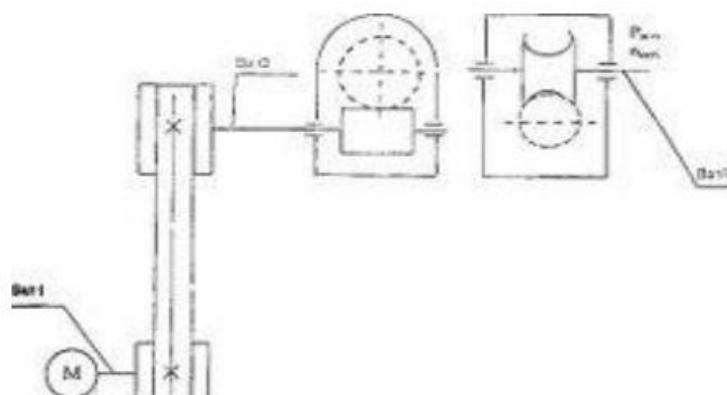
**Вариант задания № 5.** Рассчитать клиноременную передачу от электродвигателя к редуктору. Требуемая мощность электродвигателя  $P_1=5,2$  кВт при  $w_1=300$  рад/с. Передаточное число ременной передачи  $u=3$ .
