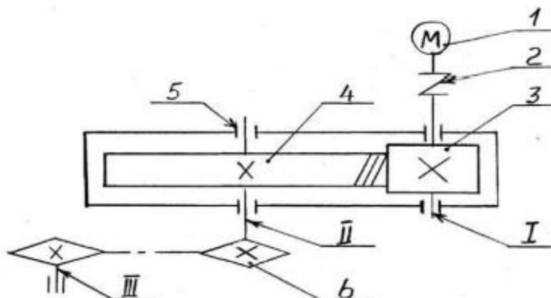
**Вариант задания № 3.** Рассчитать закрытую коническую передачу одноступенчатого редуктора привода автоматической линии. Вращающий момент на валу колеса  $T_2 = 240 \text{ Нм}$  при угловой скорости колеса  $w_2 = 53,8 \text{ рад/с}$ . Переда-
