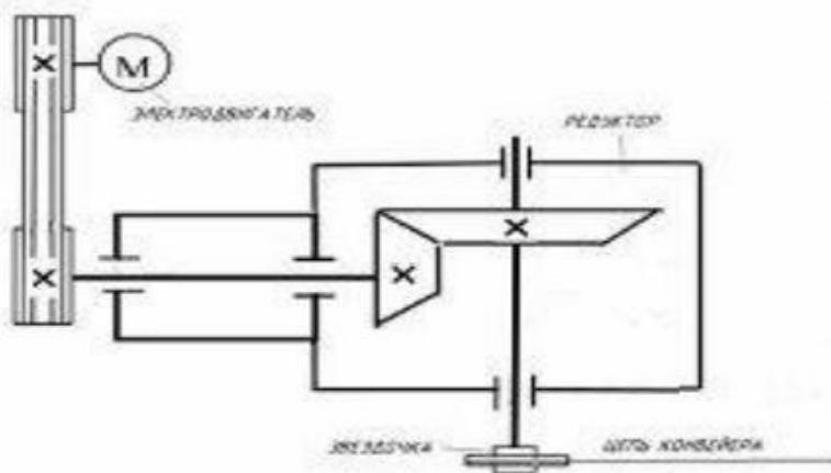
**Вариант задания № 4.** Рассчитать червячную передачу редуктора с нижним расположением червяка. Вращающий момент на валу червячного колеса  $T_2=730$  Нм при угловой скорости колеса  $w_2=4,7$  рад/с. Передаточное число  $u=21,4$ . Передача реверсивная. Нагрузка, близкая к постоянной
