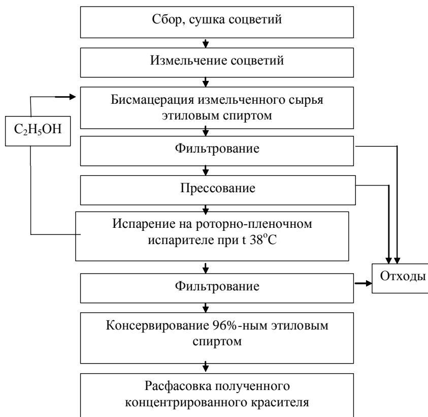
Рис. 1. Технологическая схема получения концентрированного красителя из соцветий календулы лекарственной.
