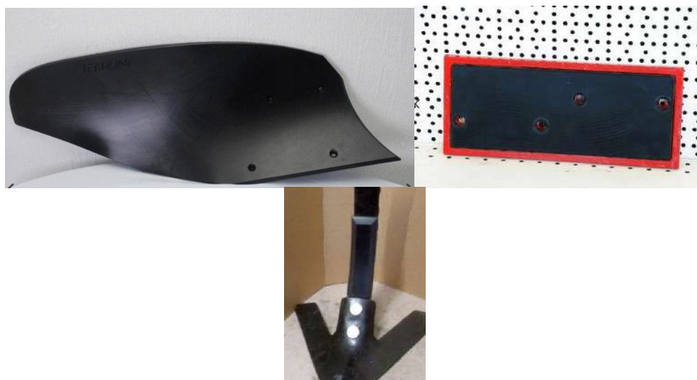
Рис. 2. Образцы элементов из композитного термопластичного материала Tekrone для рабочих органов почвообрабатывающих машин:
