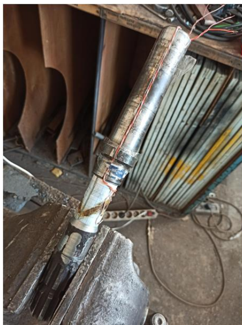
Рисунок 4.14 - Общий вид вала подшипникового узла с наклеенными тензорезисторами
