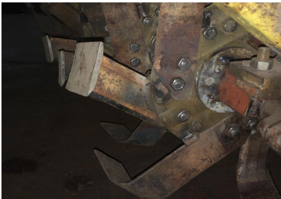
Рисунок 5.6 - Крепление ножей на диске барабана
