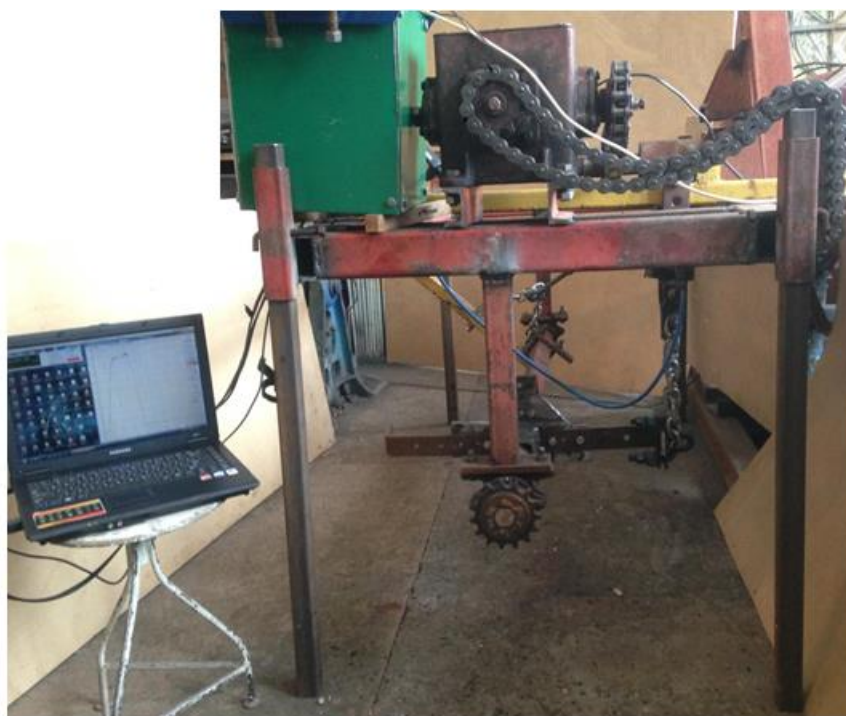
Рисунок 4.2 - Общий вид стенда для определения момента срабатывания предохранительного устройства
