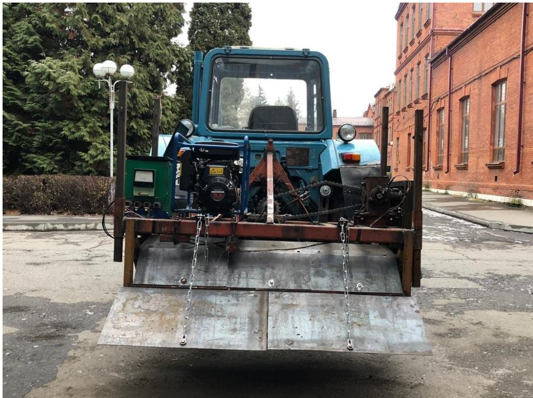
Рисунок 4.21 - Опытный образец фрезы с полным комплектом измерительного оборудования и бензиновым генератором
