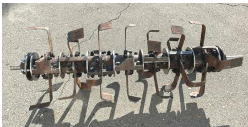
Рис. 1. Барабан фрезы с секциями, автоматически обходящими крупные камни.
