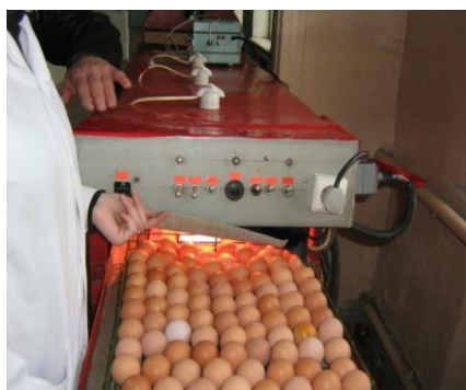
Облучение инкубационных яиц инфракрасным светом ламп ИКЗ-250
