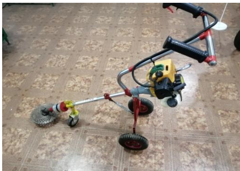
Рис.1.Механизированное устройство для кошения травы, сорной растительности, поросли кустарников
