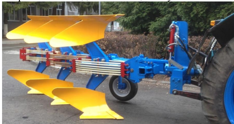
Рисунок 1.4.1 - Общий вид модернизированного 3-х корпусного оборотного плуга
