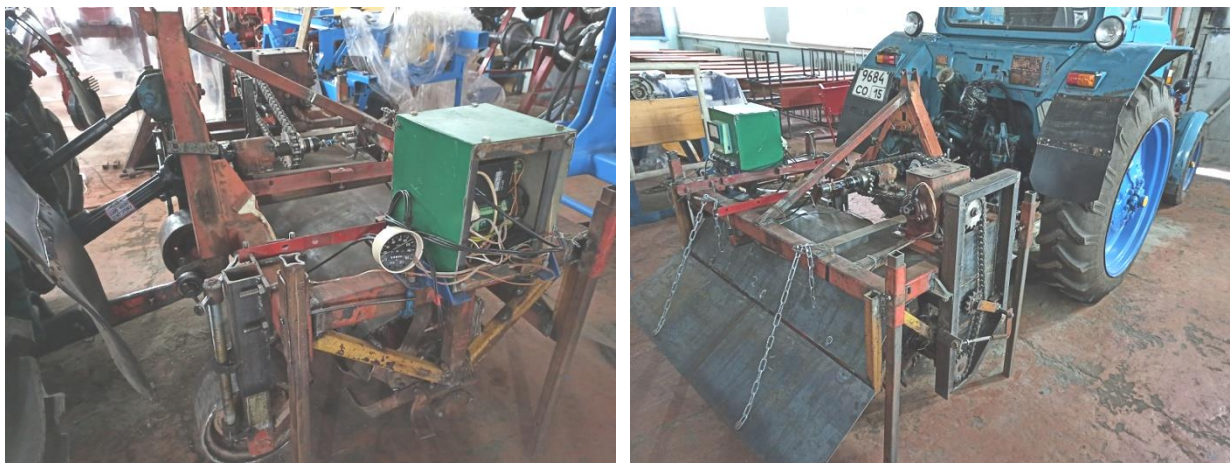
Рисунок 1 – Общий вид образца почвообрабатывающей фрезы с установленным электронно-измерительным оборудованием для проведения опытов.
