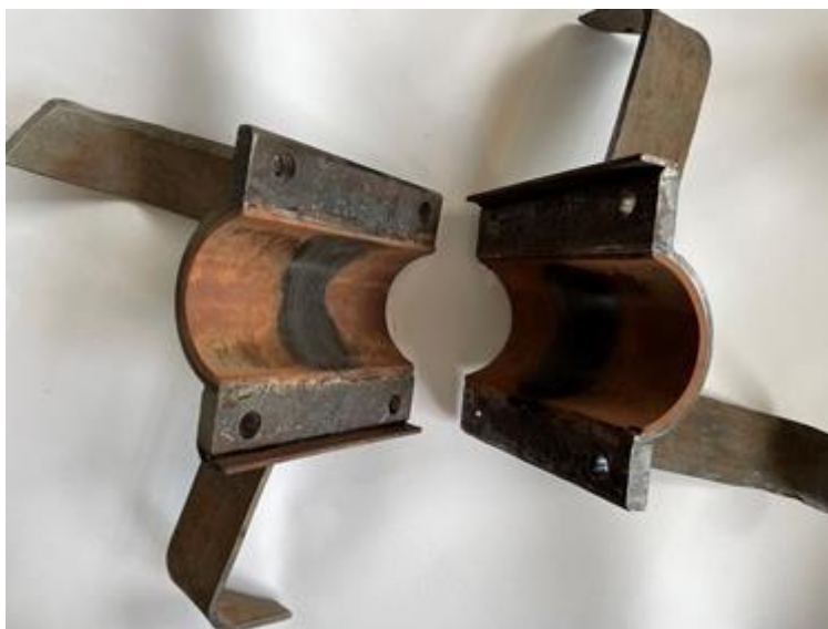
Рис. 4.1. Половинки одной секции фрезы с ножами
