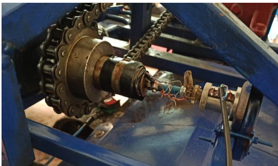
Рис.4.17. – Общий вид подшипникового узла с наклеенными на вал тензорезисторами и подсоединенным к валу токосъемником.
