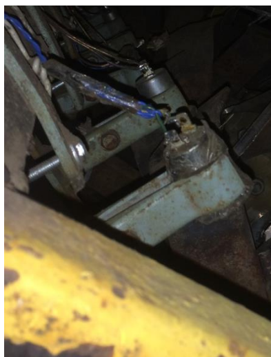
Рис.1.17. Датчики Холла, установленные над секциями
