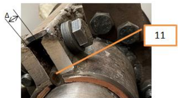
Рис.4.4. Зазор в секции \Delta и расположение уплотнителя 11.
