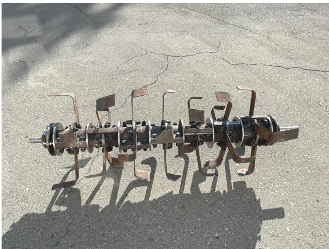
Рис. 5.1. Барабан фрезы с секциями автоматически обходящими крупные камни.
