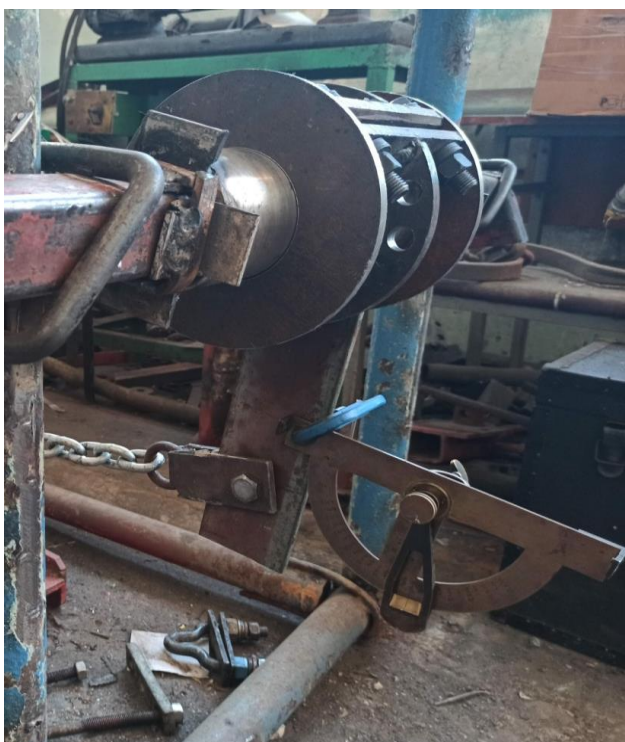
Рис. 4.6 – Установленный на стенде образец экспериментальной секции с закрепленным на ноже инклинометром
