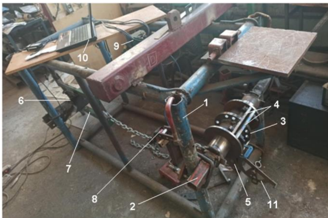
Рис. 4.5. Общий вид лабораторного динамометрического стенда с установленной экспериментальной секцией фрезы с фрикционным предохранителем: 1 – основная рама, 2 – брус квадратного профиля, 3 – образец секции, 4 - половинки секции со стяжными болтовыми соединениями, 5 – нож, 6 – винтовая пара механизма нагружения, 7 – рамка механизма нагружения, 8 – тензодинамометр, 9 – измерительный блок, 10 – портативный компьютер с установленным программным комплексом ZetLab аналого-цифрового преобразователя, 11 – инклинометр.
