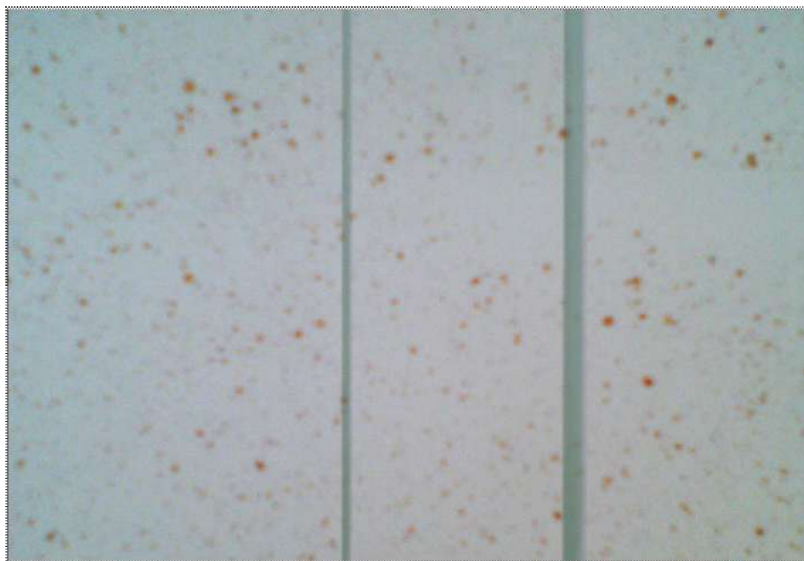
Рисунок 3. Фотография факела распыла рабочей жидкости, сделанная при P=0,35 МПа (увеличена в 10 раз).
