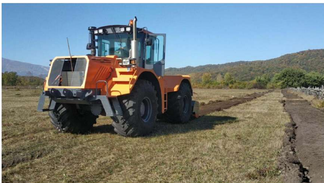
Рис. 4. Работа агрегата по прокладке посадочных полос (дробление).
