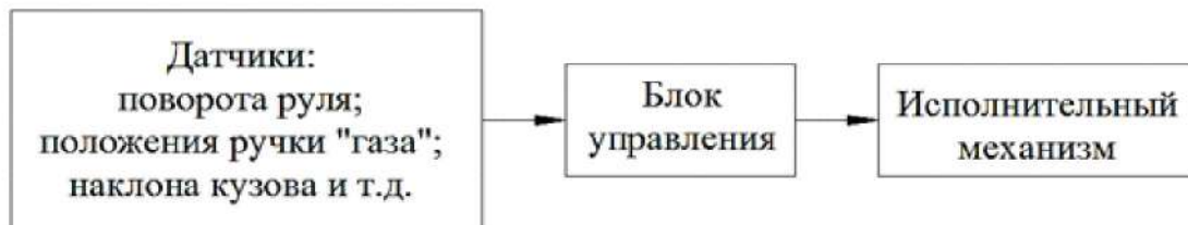
Рисунок 1. Принцип работы упреждающей системы наклона остова трицикла.
