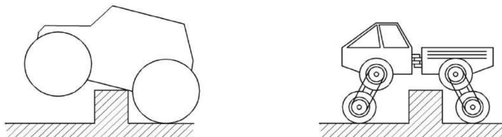
Рис. 4. Взаимодействие с препятствием различных мобильных машин.
