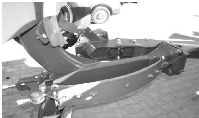
Рис.1. Предохранительная система рессорного типа фирмы Kverneland.
