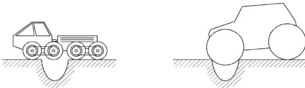
Рис. 3. Преодоление ямы или рва колесно-шагающей и колесной машинами.
