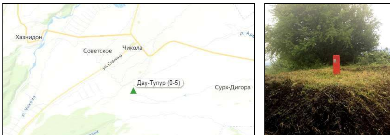
Рис. 1. Положение пункта ГГС Дау-Тупур на карте (а) и опознавательный столбик на местности (б).
