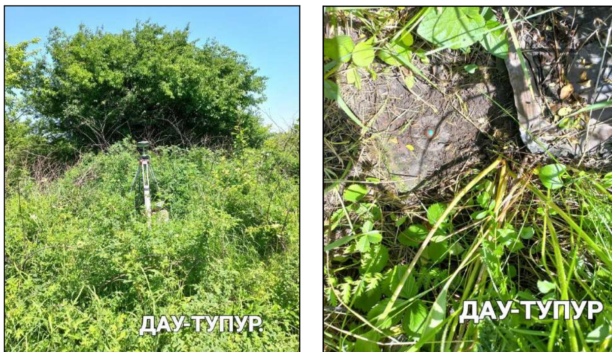
Рис. 2. Пункт ГГС Дау-Тупур: сверка астрономических координат (а); состояние марки (б).
