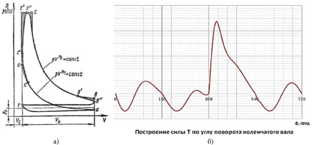
Рис. 2. Индикаторная диаграмма ДВС и результаты динамического расчета.
