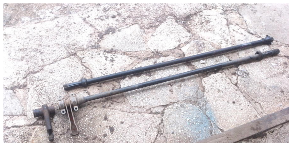
Рис. 1 – Общий вид упругих элементов торсионного типа, применяемых на автомобилях.
