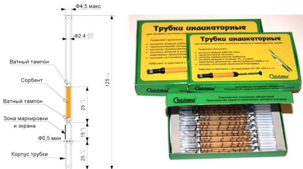
Рис. 1. Общий вид индикаторной трубки для контроля качества нефтепродуктов.
