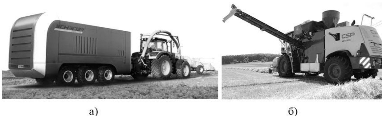
Рис. 8. Мобильные заготовщики пеллет из растительного сырья: а) Pellettec D (Австрия), б) CPS Metitron 560 (Германия)
