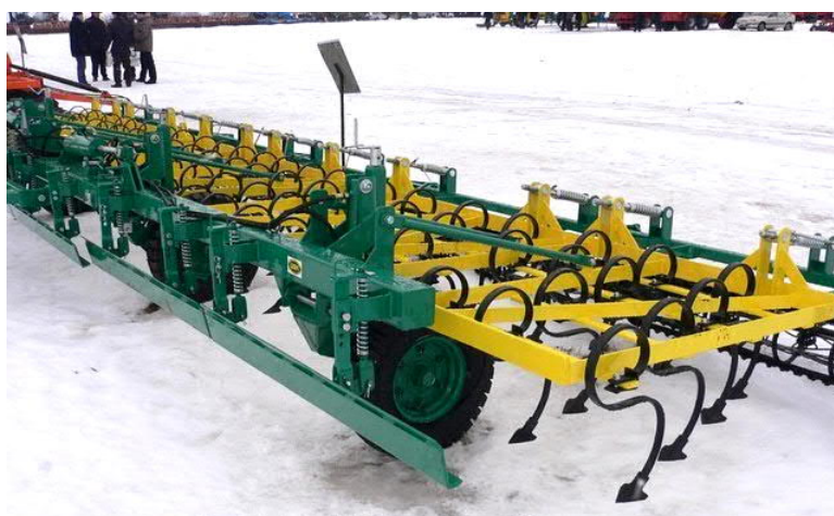
Рис. 5 Почвообрабатывающий агрегат для сплошной обработки почвы АГК 12,5
