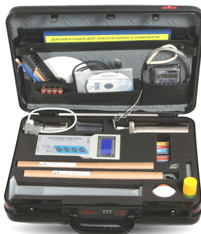
Рис. 4. - Общий вид переносной лаборатории оперативного проведения прямо-сдаточного анализа топлива 2М6
