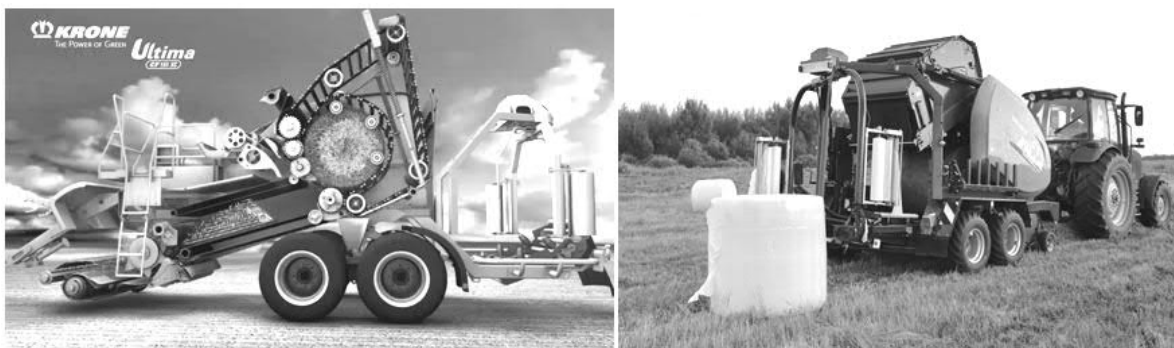
Рис. 6. Пресс-подборщики с упаковкой массы в пленку: а) Krone Ultima (Германия); б) ПРП-160-1К «Бобруйскагромаш» (Беларусь)
