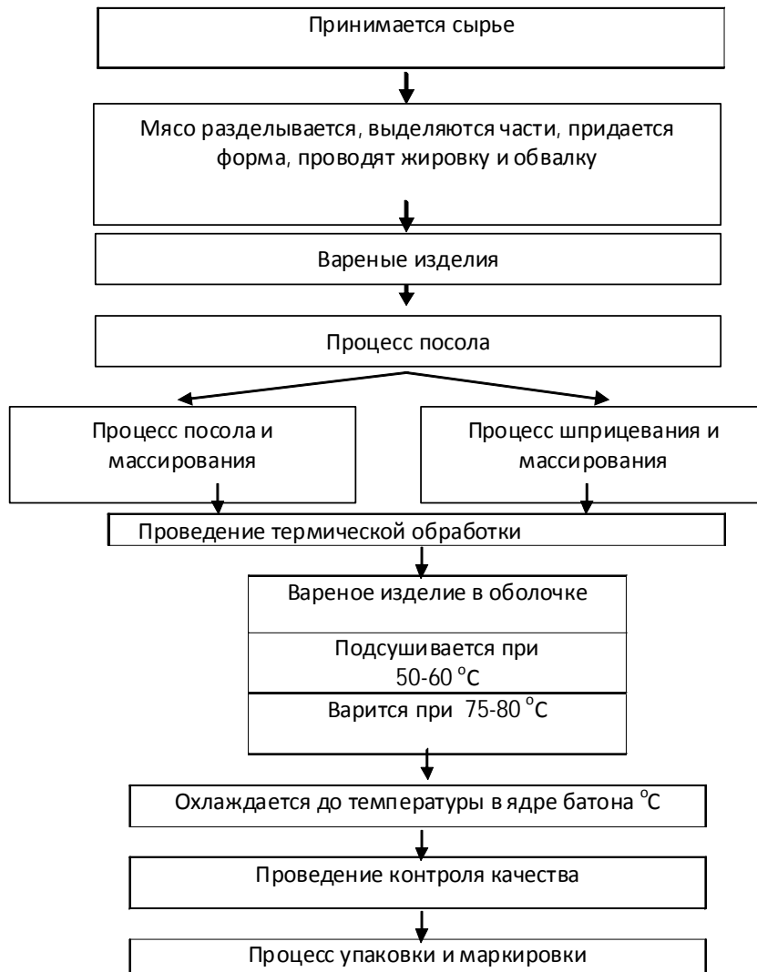
Рисунок 1 – Технологическая схема изготовления вареной колбасы.
