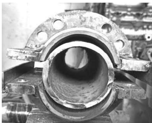
Рис. 1. Общий вид образца исследованного тормозного механизма фрикционного типа.
