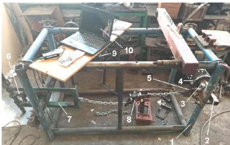
Рис. 2. Общий вид лабораторного динамометрического стенда с исследуемым экспериментальным образцом тормозного механизма:
