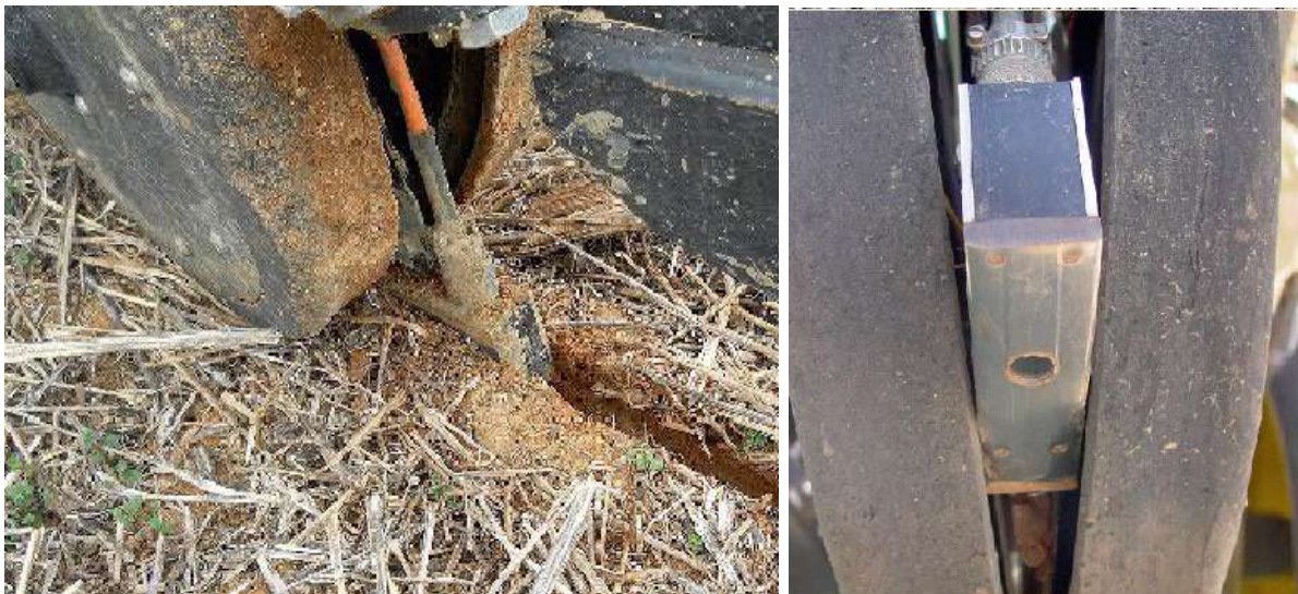
Рис. 3. Оптический сенсор для сканирование почвы на содержание органического вещества (ОМ).
