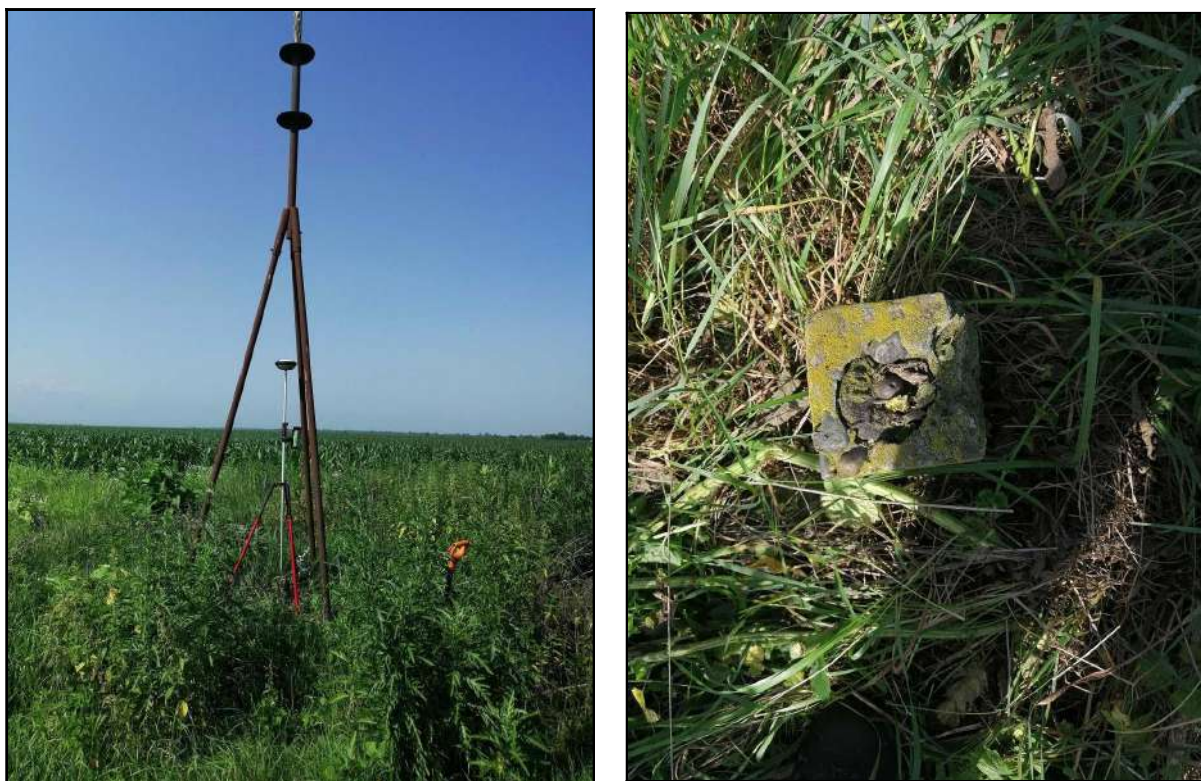
Рис. 1. Уточнение координат пункта ГГС «Ольгинское» (а) и визирная оценка центра и марки (б).
