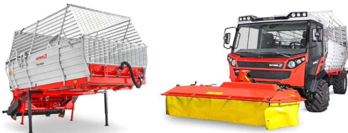
Рис. 3. Комбинированный уборочно-транспортный агрегат Reform Muli T8X в комплекте с косилкой Reform SM240 и кузовом PrimAlpin
