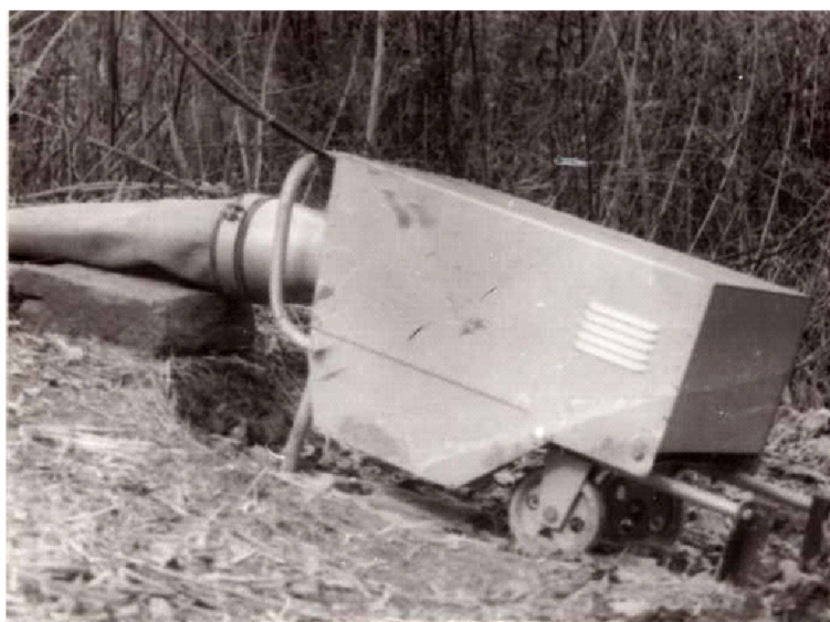
Рис. 3. Рукавная микро-ГЭС мощностью 1,5 кВт
