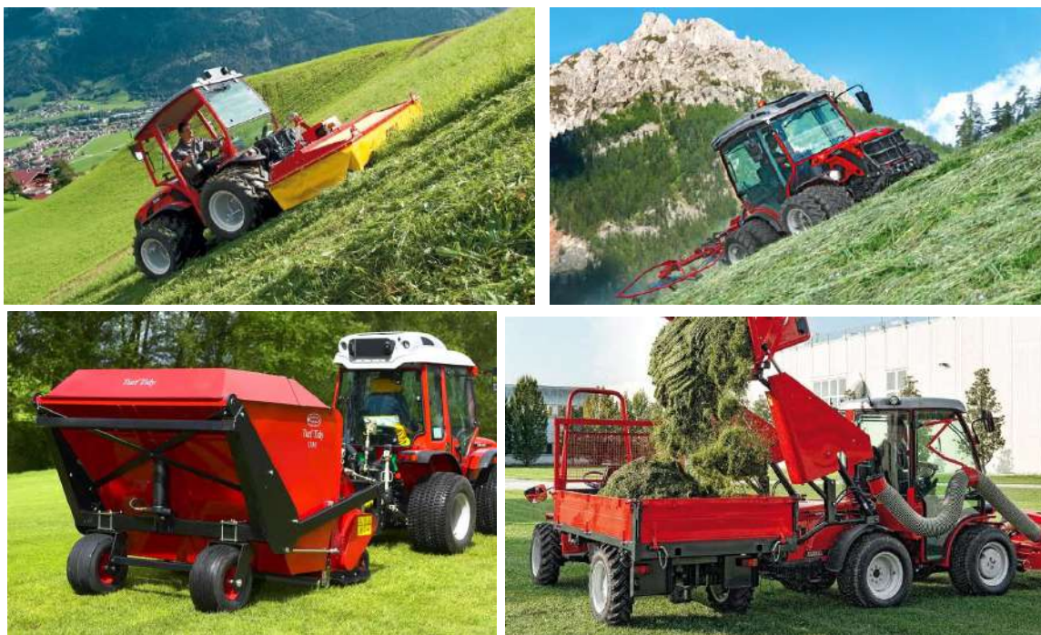
Рис. 1. Тракторы Antonio Carraro для работы на склонах в вариантах комплектации: роторной косилкой, колесно-пальцевыми граблями, подборщиком скошенной массы
