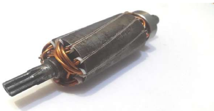
Рис. 2. Модернизированный ротор с обмоткой в виде отдельных рамок.
