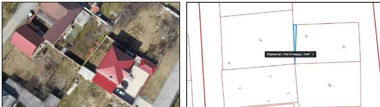
Рис. 2. Съёмка с квадрокоптера земельных участков :16 и :19 (а) и ситуативный снимок с ПКК Росреестра (б).
