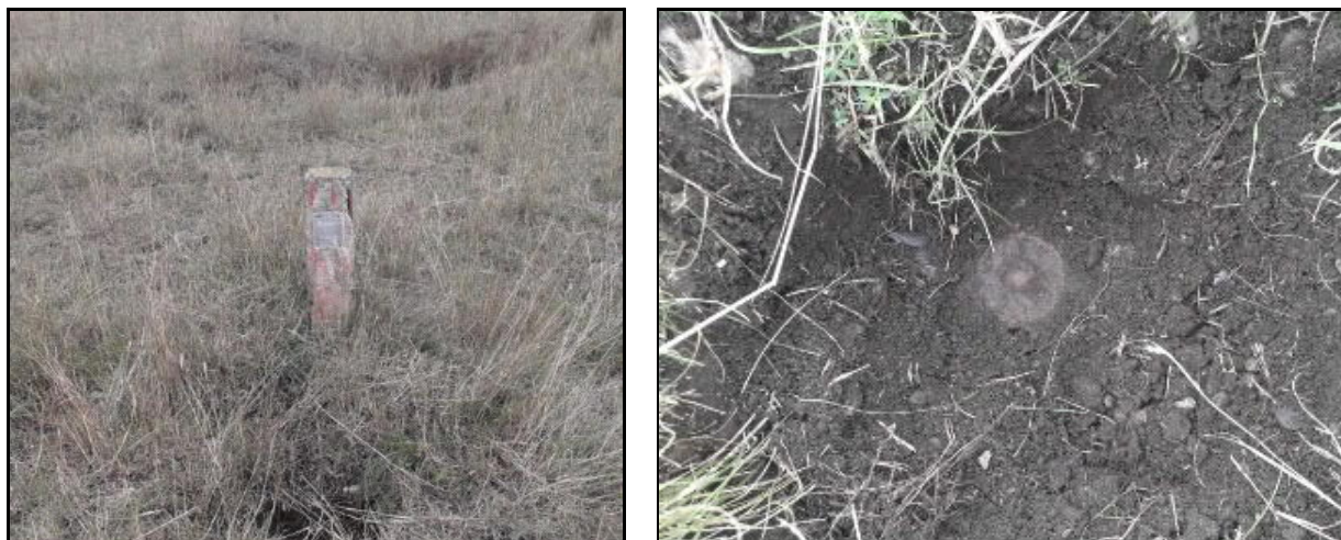
Рисунок 2 – Оознавательный столбик геоточки «071591» (а) и состояние марки (центра) (б)
