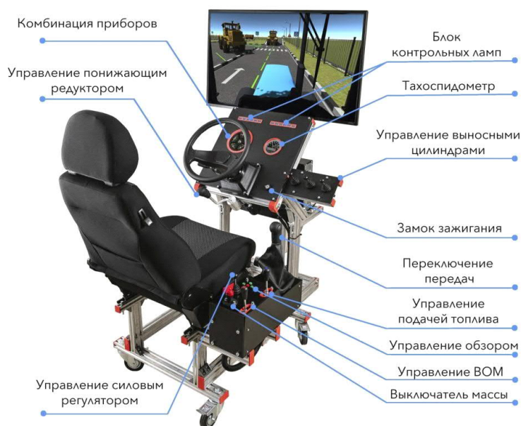
Рисунок 1 – Учебный тренажер «Трактор-Студент» с компьютерной программой Sim Tractor 2020, содержащей набор учебных упражнений по принципу «от простого к сложному» и предназначенный для тренировки навыков управления [6].
