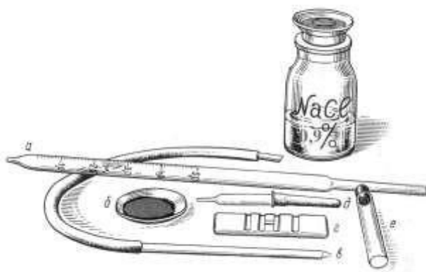
Рис. 1 – Оборудование, необходимое для подсчёта эритроцитов: а – химическая пипетка; б – чашечка для крови; в – капиллярная пипетка; г – камера Горяева; д – глазная пипетка, е – пробирка Флоринского
