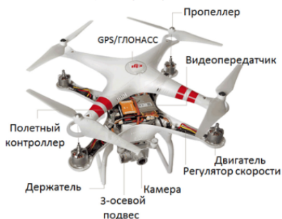
Рисунок 1.3 – Устройство беспилотника вертолетного типа
