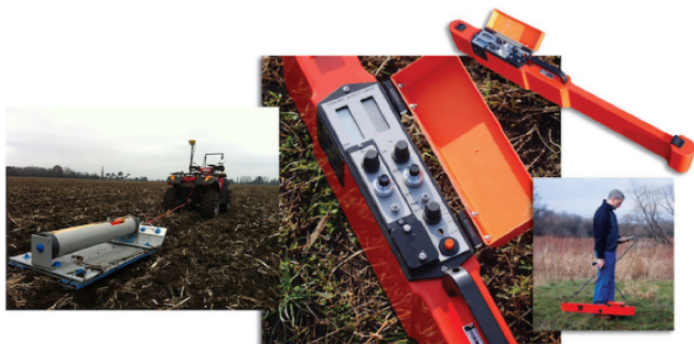
Рисунок 1.6 – Датчик отображения проводимости почвы EM-38-MK2
