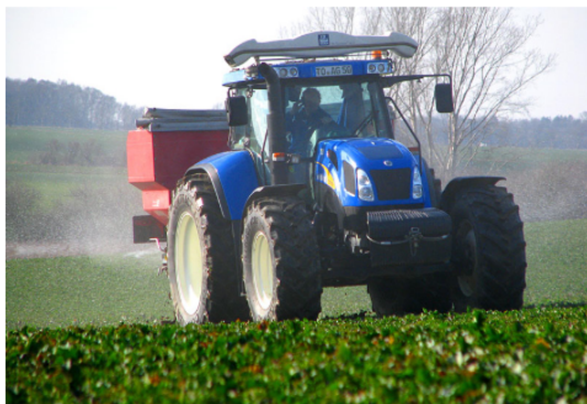
Рисунок 1.9 – Трактор с установленным на крыше Yara-N-сенсором
