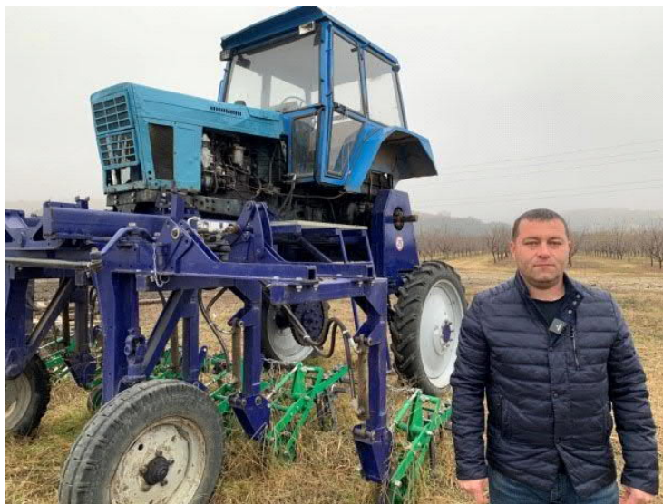
Рисунок 1 – Высококлиренсная платформа ВП-1,5 для междурядной работы в питомнике.
