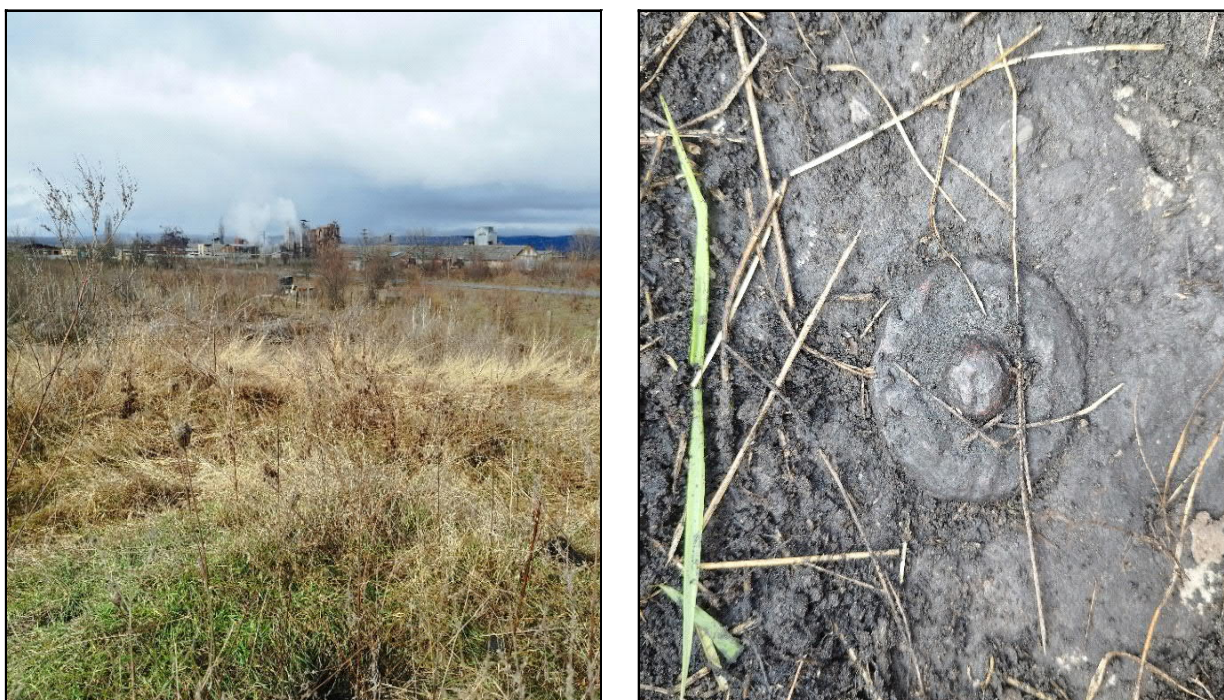
Рисунок 2 – Состояние марки (центра) обследуемого пункта ГГС «Кау-Дале».
