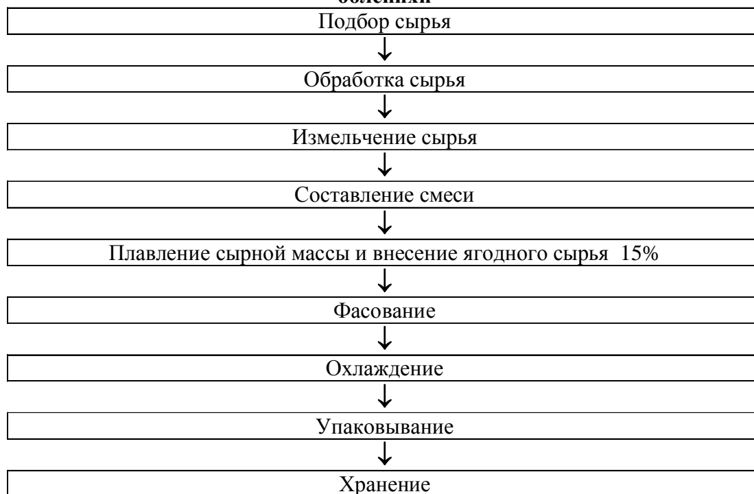
Рисунок 1 – Схема технологии производства плавленых сыров с добавкой
