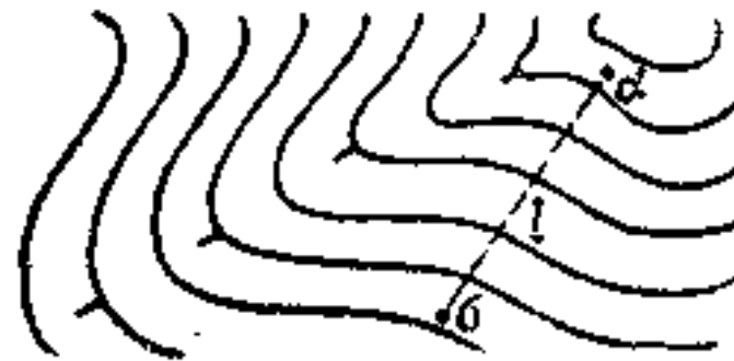
Рис. 13. Схема к определению превышения точек.
