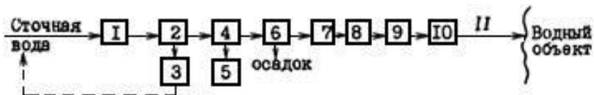
Рис. 6.2.1. Схема очистных сооружений с биофильтрами:
